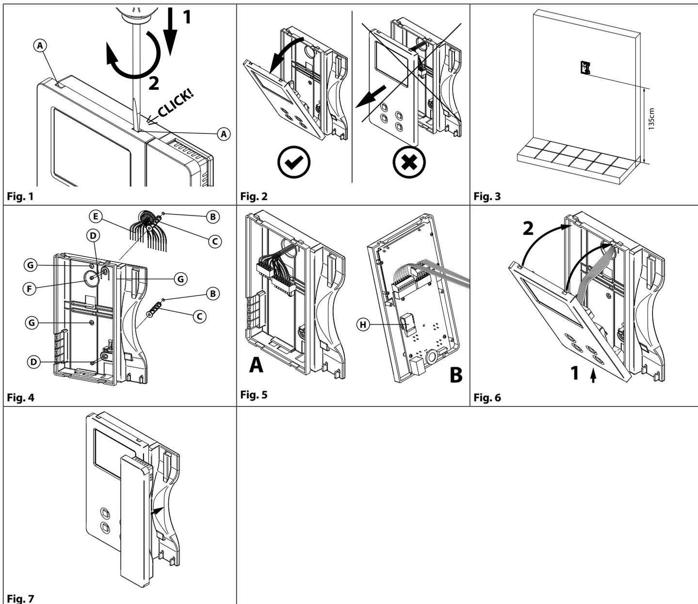
1. Pour installer l'interphone vidéo il faut l'ouvrir en séparant la base du couvercle qui contient toute son électronique : débrancher le combiné de l'interphone vidéo en enlevant le plug correspondant donc, introduisez la pointe d'un tournevis plat de 5,5 mm dans la clip (A), après tournez-le dans le sens inverse des aiguilles d'une montre jusqu'à que vous écoutez un « **CLIC!** ». Répétez la même opération avec l'autre clip comme indiqué sur la **Fig. 1**.
